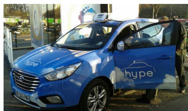
électrique alimenté par une pile à hydrogène. Celle-ci produit de l'électricité grâce à l'hydrogène haute pression, stocké dans le réservoir du véhicule, et l'oxygène de l'air. Le véhicule ne rejette que de la vapeur d'eau. Son autonomie atteint 500 km, soit trois fois plus qu'un véhicule électrique à batterie. La recharge demande moins de cinq minutes.
