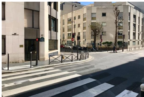
Le passage protégé a été reporté plus en amont et une barrière courbe canalise les piétons
